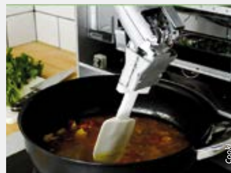
«Cooki» heisst ein Roboter, der Wokgerichte zubereitet. Der Arm kann für die Reinigung problemlos abgenommen werden.
